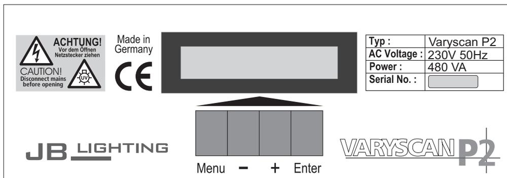
Am Bedienfeld im Fuß des Gerätes können sämtliche Parameter des Varyscan P2 eingestellt werden. (siehe Menü-Übersicht nächste Seite)
