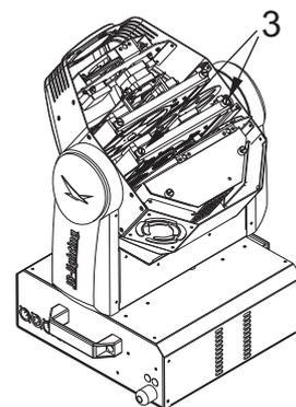
Die Gobos sind mit einer Feder in das Gobo Zahnrad gespannt. Zum Wechseln lösen Sie diese und befestigen Sie dann das neue Gobo. Beim Einsetzen von Metallgobos ist darauf zu achten, daß die schwarze lackierte Seite Richtung Objektiv zeigt und nicht Richtung Leuchtmittel. Ebenso bei Glasgobos muß die beschichtete Seite Richtung Objektiv zeigen. Bei Gobos die sich nicht verdrehen dürfen z.B. Logos, empfehlen wir das zusätzliche sichern des Gobos mit einem Tropfen Silikon.
