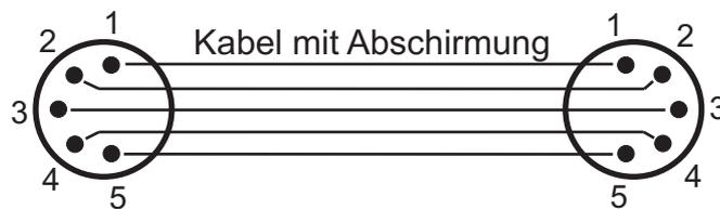
Die DMX Kabel von Varyscan zu Varyscan werden eins zu eins verbunden.
